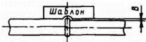
Рис. 11. Схема определения смещения кромок стыкуемых труб
